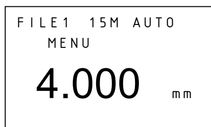
图12 探头离开被测材料
