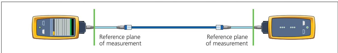
圖片1：通道測試基準平面
