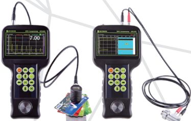
标配EMAT和UT两类超声探头
