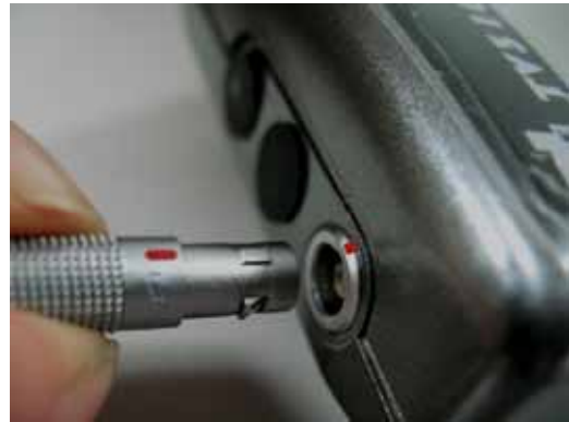
图 3.1 测振探头与测振仪连接图
