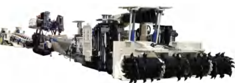
“煤海蛟龙”掘支运一体化快速掘进系统
