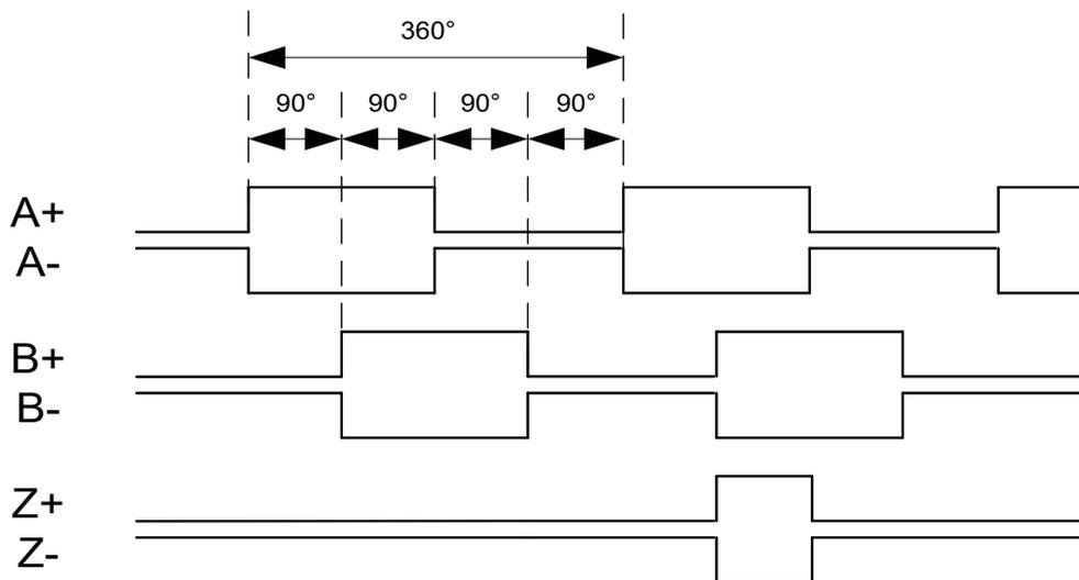
产品可以选用差分或者单端 ABZ 接口输出，差分 ABZ 接口兼容 RS422 接口电平，协议定义如上图所示。单端 ABZ 接口采用 LVTTTL 接口电平，协议只保留差分接口的正相端。
