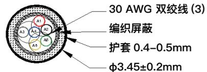
线缆直径： $\varnothing 3.45 \pm 0.2 \text{mm}$ ；
