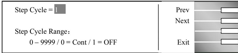
此功能为设定该步骤的执行次数。当步骤测试次数设为 0 时，即表示连续测试，直到使用者按“TEST/RESET”键或测试异常才会停止测试；设为 1 时表示不做连续测试，即仅测试一次就结束；设为 2-9999 即表示测试次数。（参照后文“系统参数设定”之“循环次数（Loop Cycle）设定”）
