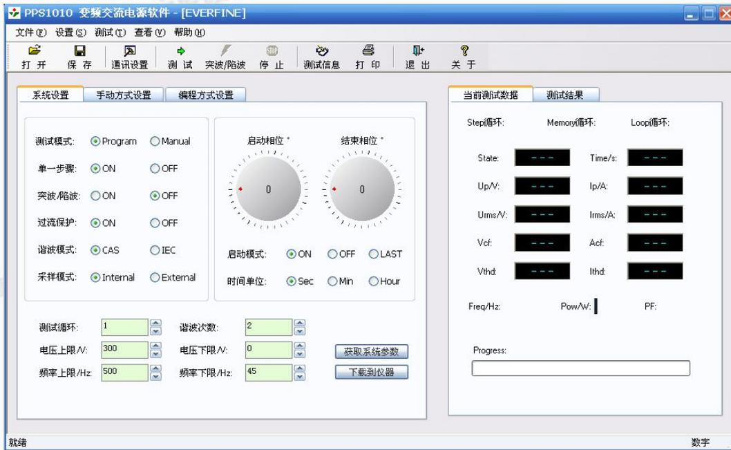
图 8.1 PPS 上位机操作界面示意图
