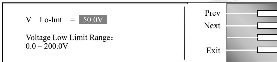
此功能可以限制及调整电压的下限值，让使用者在待测或 TEST 输出时不能轻易的调整变更电压的设定，以免超出被测物允许输入的电压范围。
