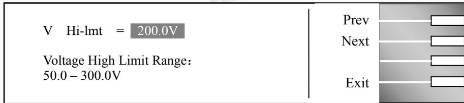
此功能可以限制及设定输出电压的上限值，让使用者在待测或 TEST 输出时不能轻易的调整变更电压的设定，以免超出被测物允许输入的电压范围。
