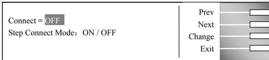
步骤和步骤间的连结，若第 1 步骤其步骤连结功能设为“OFF”，则在第 1 步骤测试通过后停止测试，不会再做第 2 步骤的自动的测试；若第 1 步骤连结功能设为“ON”，则在第一步骤测试通过后，会自动启动第二步骤继续测试。
