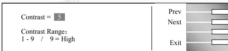
输入选择 1~9，按下 Enter 键，显示器会立即改变 LCD 的对比度，以供立即检视对比度是否适当。如须修改对比度，可以直接输入数值进行修改，在 LCD 对比度设定完成后，程序会自动将所设定的对比度数字进行存储。LCD 对比度 1 为最弱，9 为最强。
