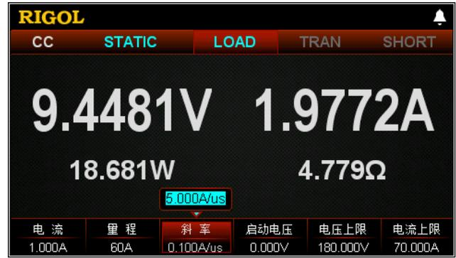
电流上升速度定义了负载在两种设定参数之间切换的速度，可以通过改变电流上升速度的大小来设定负载从一个设定值转换到另一设定值的转换时间。可调电流上升速度为0.001 A/μs~5 A/μs。
