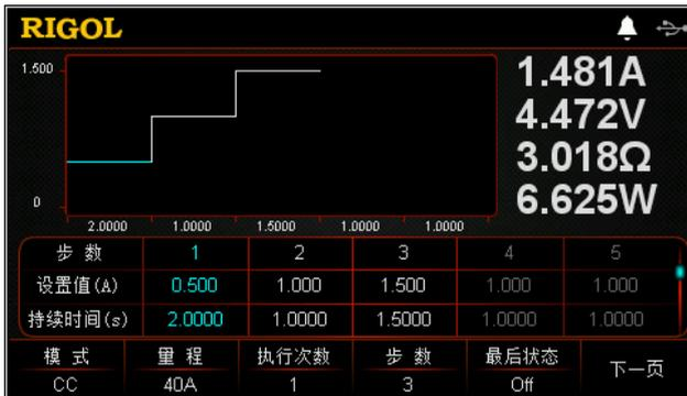
通过编辑单步的设置值、持续时间和斜率(仅CC模式下)，List功能可以生成多种复杂的序列，以满足复杂的测试需求。
