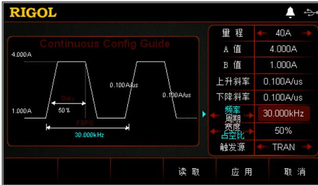
动态测试功能能够使负载根据设定的规则在两种设定参数间（A值和B值）进行切换，此功能可以用来测试被测设备的动态特性，其中频率最高可设置为30 kHz。此外，在向导界面中，用户可以在参数配置列表中设置相关参数，并通过参数配置向导图直观的进行查看。
