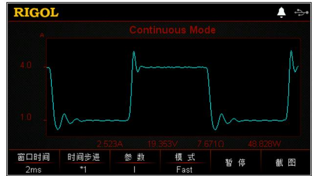
负载提供波形显示功能，并支持对波形进行暂停、记录和截图等操作，方便用户通过动态波形来观察参数的变化趋势。
