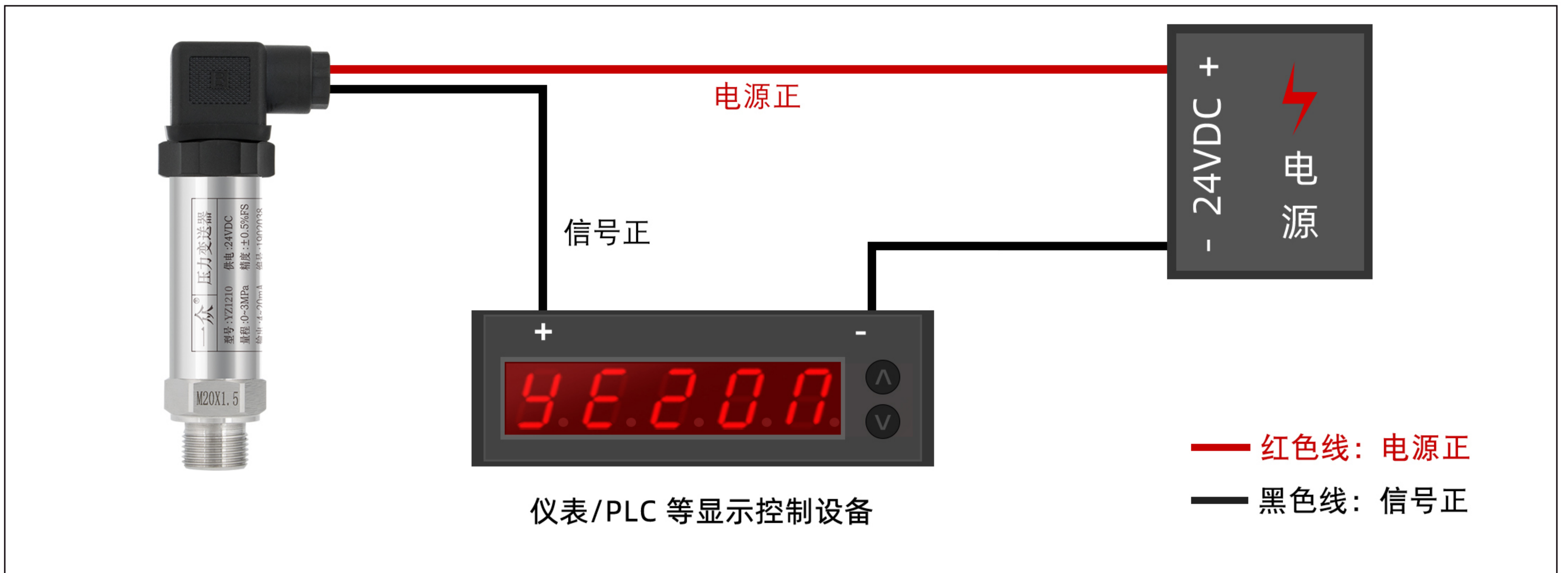
三线制:电压输出0-5V/0-10V/1-5V接线示意图
