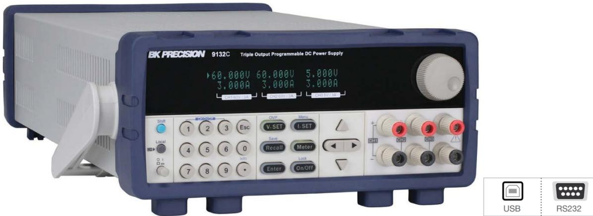
9130C 系列三输出线性可编程直流电源具有隔离功能, 可独立调整的输出串联或并联组合以输出更高电压或电流。此外, 这些用品可以在追踪模式下操作用户可配置的频道之间的比率。
