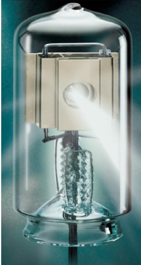
氙灯是一种内部充有氙气的气体放电光源，它可产生 190-400nm 波长的紫外连续光谱，常用在液相色谱仪 (HPLC), 紫外分光光度计 (UV-VIS), 原子吸收光谱仪 (AAS), 毛细管电泳仪 (CE)。
