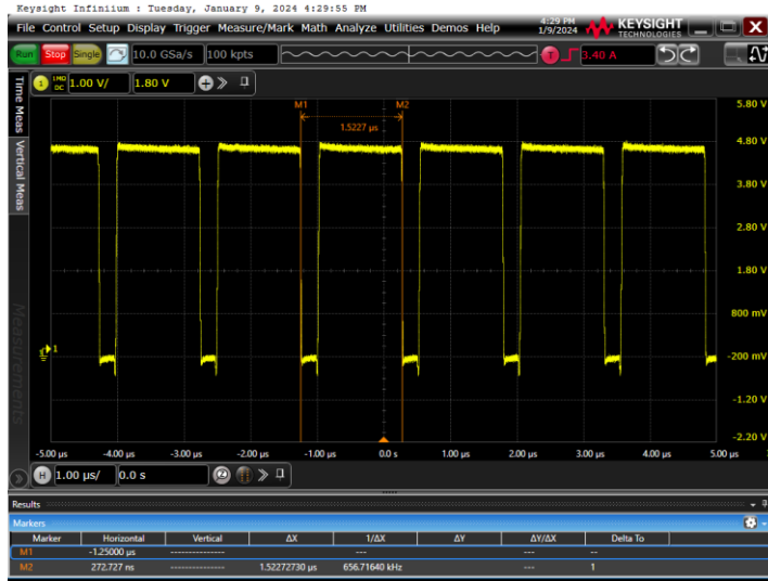
IP5365 充放电开关频率示波器图片
