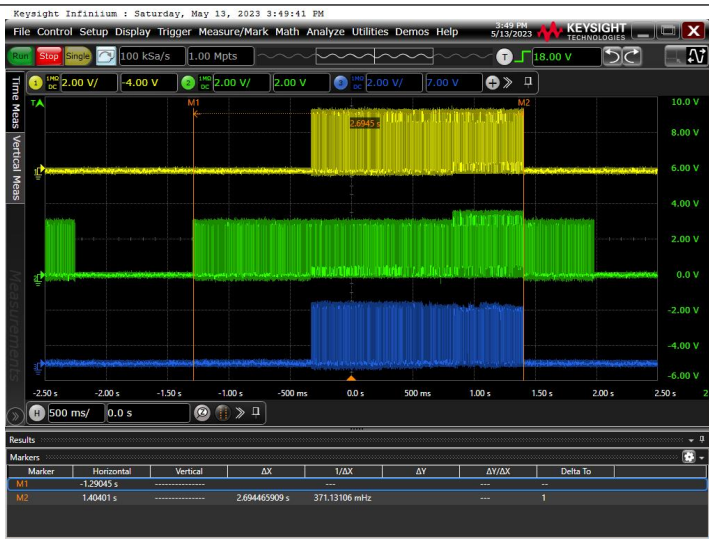
IP5385 闪灯频率示波器图片
