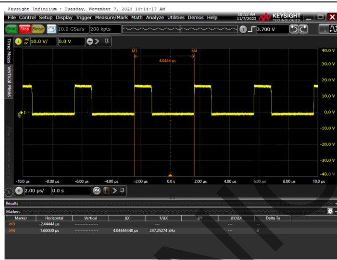
IP5389H 充放电开关频率示波器图片
