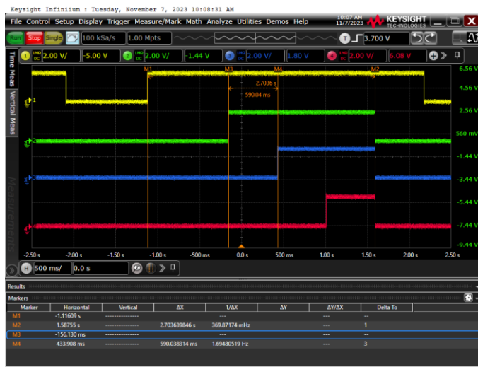
IP5389H_S1AACC_BZ 闪灯频率示波器图片
