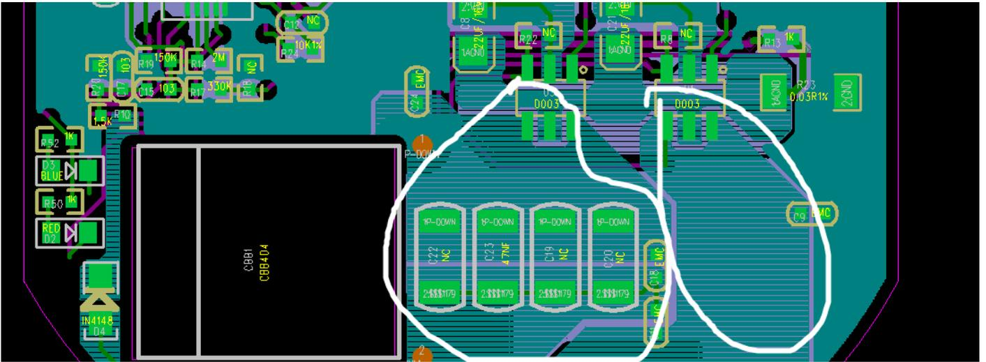
4. EMI 辐射元件位置，C4 要保证靠近电源输入端，C9、C24 放置 MOS 输出极旁，C11、C18 要靠近线圈和电容放置。
