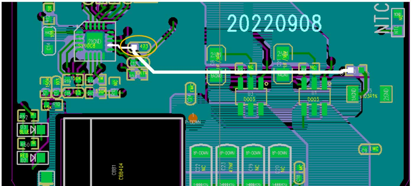
3. 线圈和谐振电容敷铜面积尽量要大，保证路径环路面积尽可能短。
