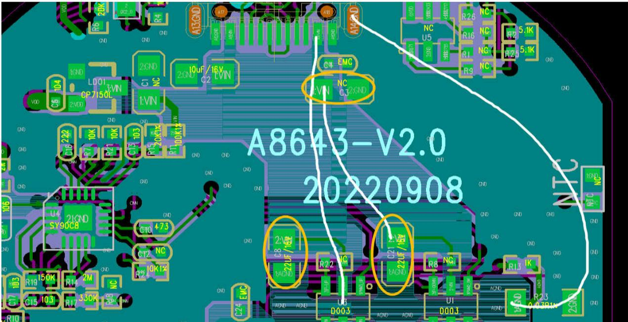
2. 采样电阻（0.03R）的 GND 与系统的 GND 连接要良好，多打过孔接到系统 GND，采样线跟其他谐振路径隔离，防止其受到干扰，C10 要靠近 IC 引脚起滤波作用。
