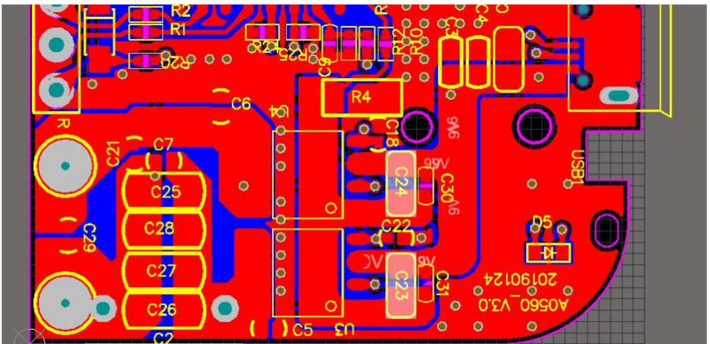
2、采样电阻的 GND 与系统的 GND 之间连接要良好，多打过孔连接到系统 GND；采样信号线尽量跟其他信号隔离，防止其受到干扰，C10 要靠近 IC 引脚起滤波作用。
