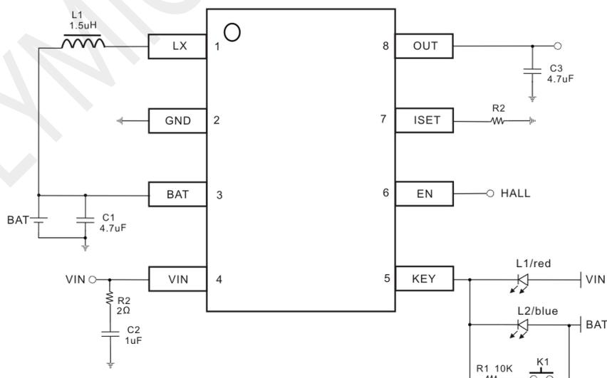
注：电阻 R2 可以极大程度减小 USB 插入尖峰电压，建议保留
