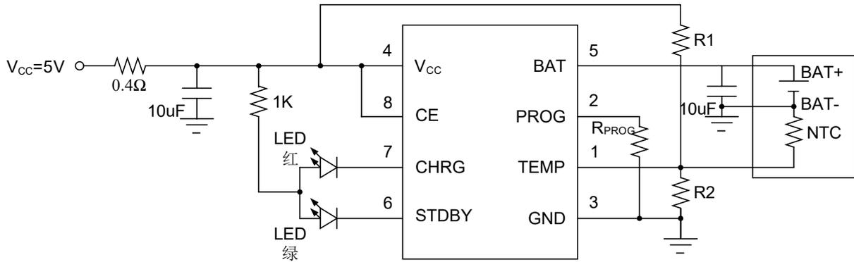
假设电池正常温度范围为 $T_L \sim T_H$ ， $R_{TL}$ 为热敏电阻在温度 $T_L$ 时的阻值， $R_{TH}$ 为热敏电阻在温度 $T_H$ 时的阻值。则在温度 $T_L$ 时TEMP端电压为：
