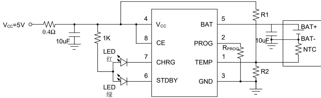
注:  $V_{CC}$  与外部电源之间串联的  $0.4\Omega$  电阻, 为热散耗功率电阻。可以转移一部分 CP4056A 的发热, 小充电电流可不加。
