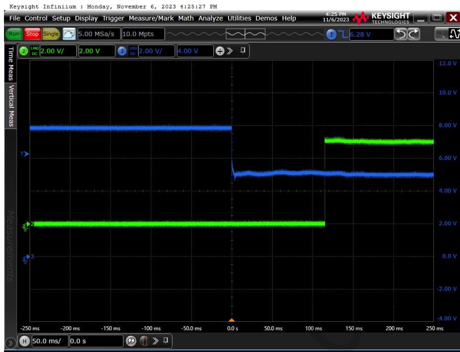
图 7 VIN 过压恢复 (VIN=7V-5V)
