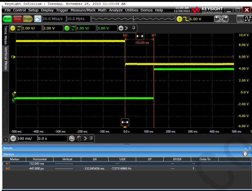
图7 VIN 过压恢复 (VIN=9V-5V)
