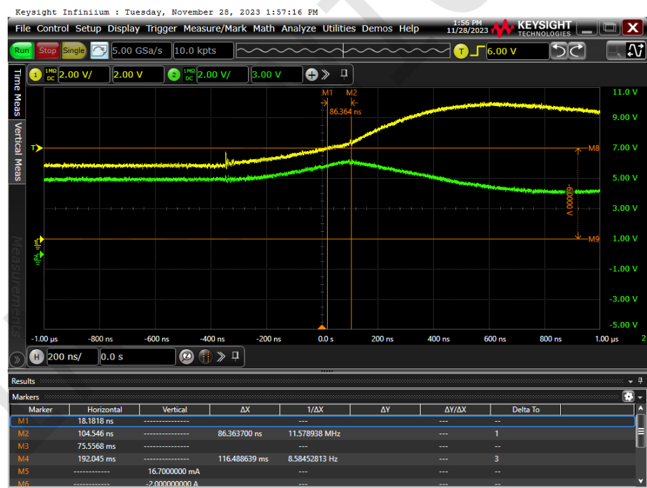
图 6 VIN 过压保护 (VIN=5V-15V)
