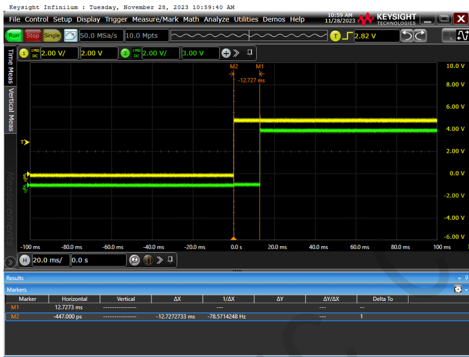
图 5 VIN 正常上电启动 (VIN=5V)
