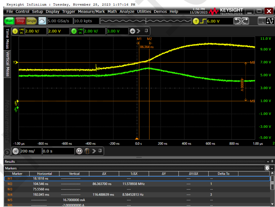
图 6 VIN 过压保护 (VIN=5V-15V)
