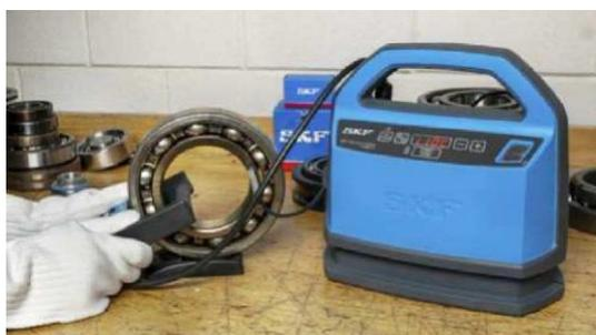
本设备具有近乎无声的性能，重量仅为 3 kg，这主要归功于采用了先进的中频技术。它有一个包含内部线圈的感应加热钳。线圈中的电流产生不断波动的磁场。这会在元件中产生电流，从而产生热量。因为这种热量是在元件内部产生的，而不是在加热钳中产生的，所以这个过程非常高效。
