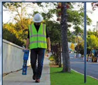
带有阴极保护系统的管道可以使用 CPS 被动模式进行跟踪。CPS 罗盘模式可确保与目标管道方向一致。
