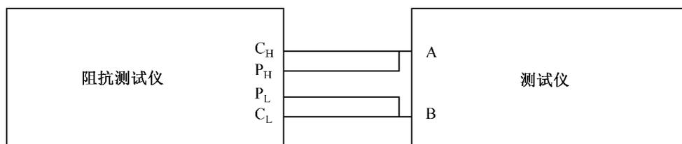
图 4 输入阻抗测量设备连接示意图
