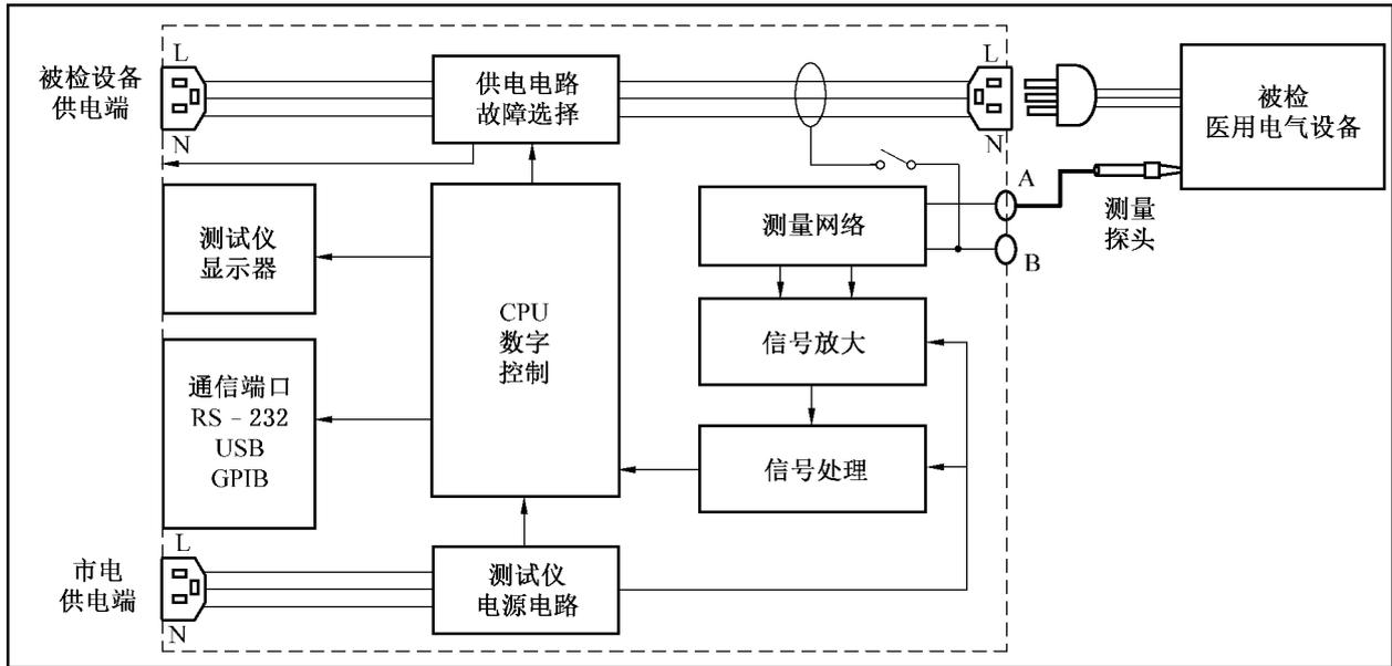
图 1 测试仪的工作原理示意图
