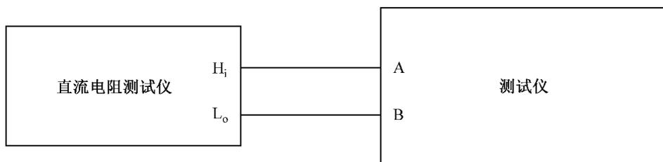
图 3 直流输入电阻测量设备连接示意图
