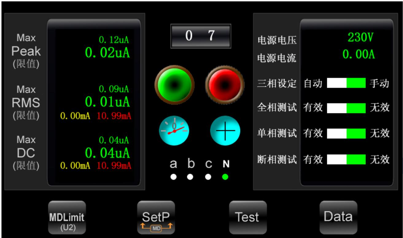
数据显示输出: DC (直流)、Peak (峰值)、RMS (有效值) 同时显示, 被测物电压显示, 时间显示, 上限下限报警设置
