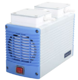
Chemker 410 最大真空度: 10 mbar 最大流量: 20 (18) L/min
