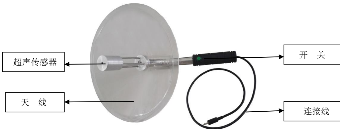
手持式超声波聚能器示意图
