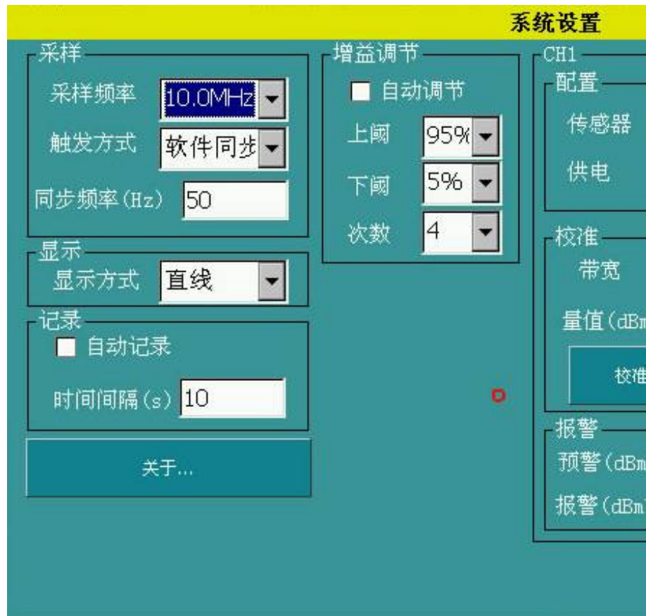
图5-5 系统设置对采样、显示、记录以及增益调节的设置
