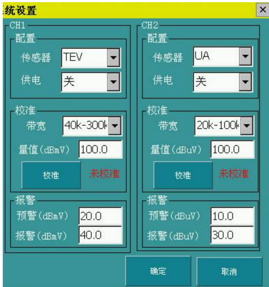
图5-7 系统设置中对 CH1 和 CH2 分别进行设置
