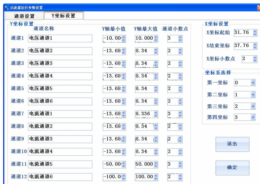
图 14 示波器的坐标设置
