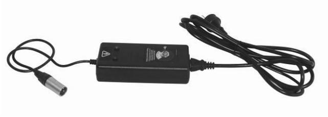
低压适配器用于把发射机直接接到低压带电电缆上，并给低压电缆注入音频信号。适用电压范围 100V - 250V AC。适配器一端接发射机，另一端可以直接插在室内电源插座上。
