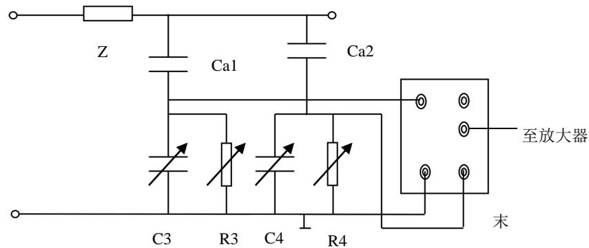
图中：Ca——试品 Ck——耦合电容 Z——高压保护电阻
