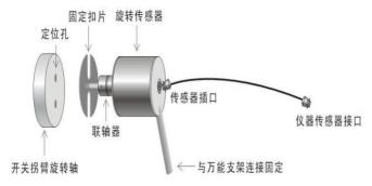
安装注意:旋转传感器的轴应尽量与开关旋转轴保持同心,否则传感器旋转有阻碍,测出曲线的毛刺会很重,影响测试数据的准确。
