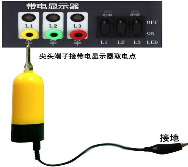
带电显示器核相示意图（图 3）
