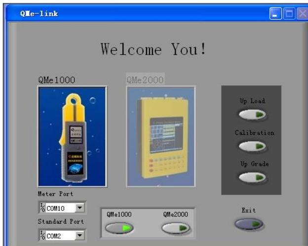
将钳形表和电脑用串口线连接，然后选择方块处的 QMe1000 钳形表，将 Meter Port 定义为电脑和仪器连接的串口号（注意：此处根据不同电脑将有不同选择，图中的 COM10 视用户所用电脑的串口配置而定，例 1：用户电脑有 2 个串行口，而钳型表连接的是 COM1，则 Meter Port
