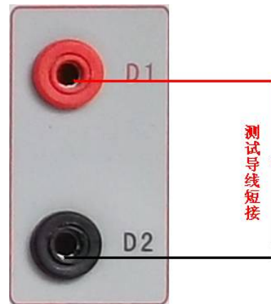
图 22，导线阻值清零接线图
