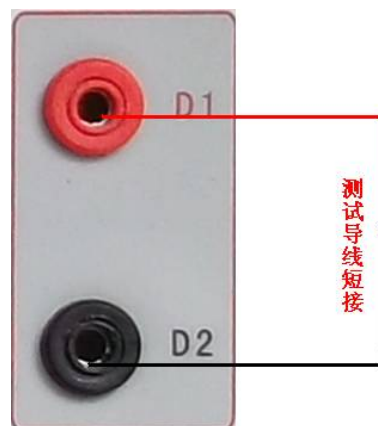
图 36, 导线阻值清零接线图
