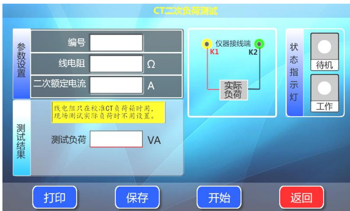
图 11, CT 二次负荷测试界面
