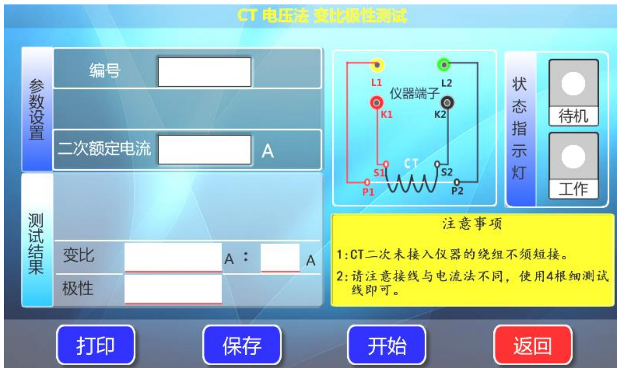
图 7，CT 电压法变比极性测试界面
