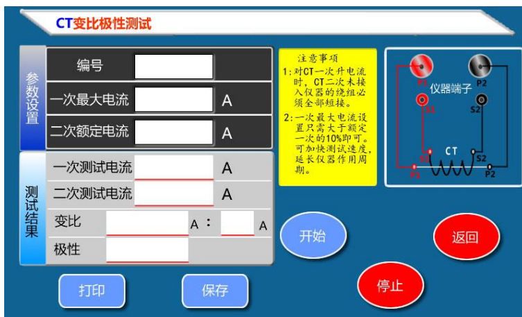
图 6, CT 电流法变比极性测试界面
