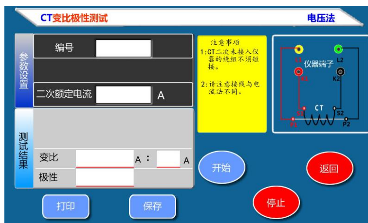
图 7, CT 电压法变比极性测试界面
