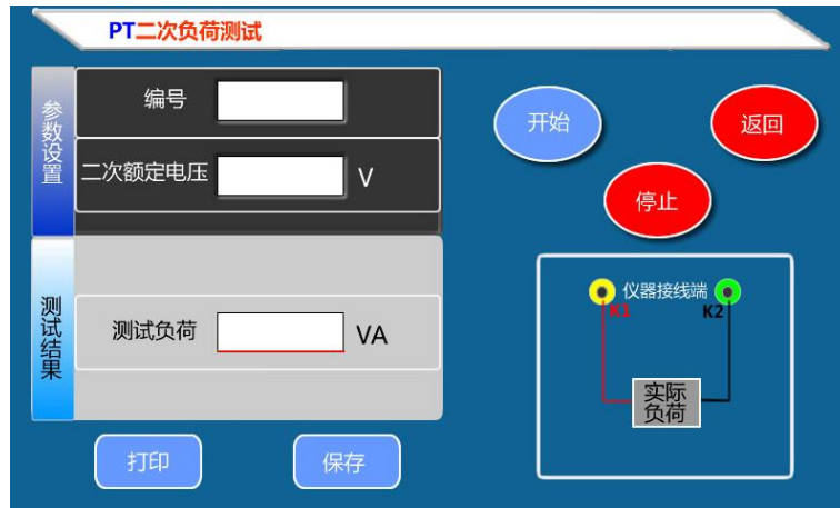
图 18, PT 二次负荷测试界面
