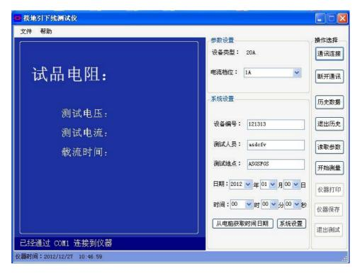
点击左上角 COM1,再点击右上角"通讯连接",软件主界面左下角会提示"已经通过 COM1 连接到仪器";在"参数设置"区域可以修改:电流档位。在"系统设置"区域可以修改:设备编号,测试人员,测试地点和设备显示时间。点系统设置发送至仪器。
