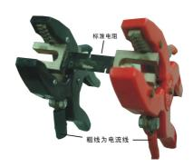
其中标准电阻为 75A, 1mΩ左右。可以用来检测仪器的基本功能。标 准电阻和测试线按左图连接。需要注意:测试线的夹子夹住标准电阻时, 电流线必须同时向上或向下。
