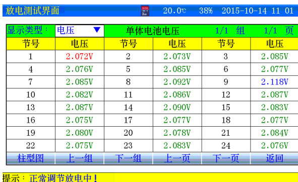
图 3.2.4 单体电压数据
