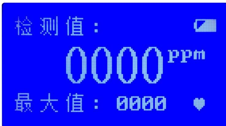
如图所示，仪器初始化完成进入待机状态这时“♥”不会闪烁。待机界面会显示“检测值：0000ppm”，“最大值：0000”，电池电量。
