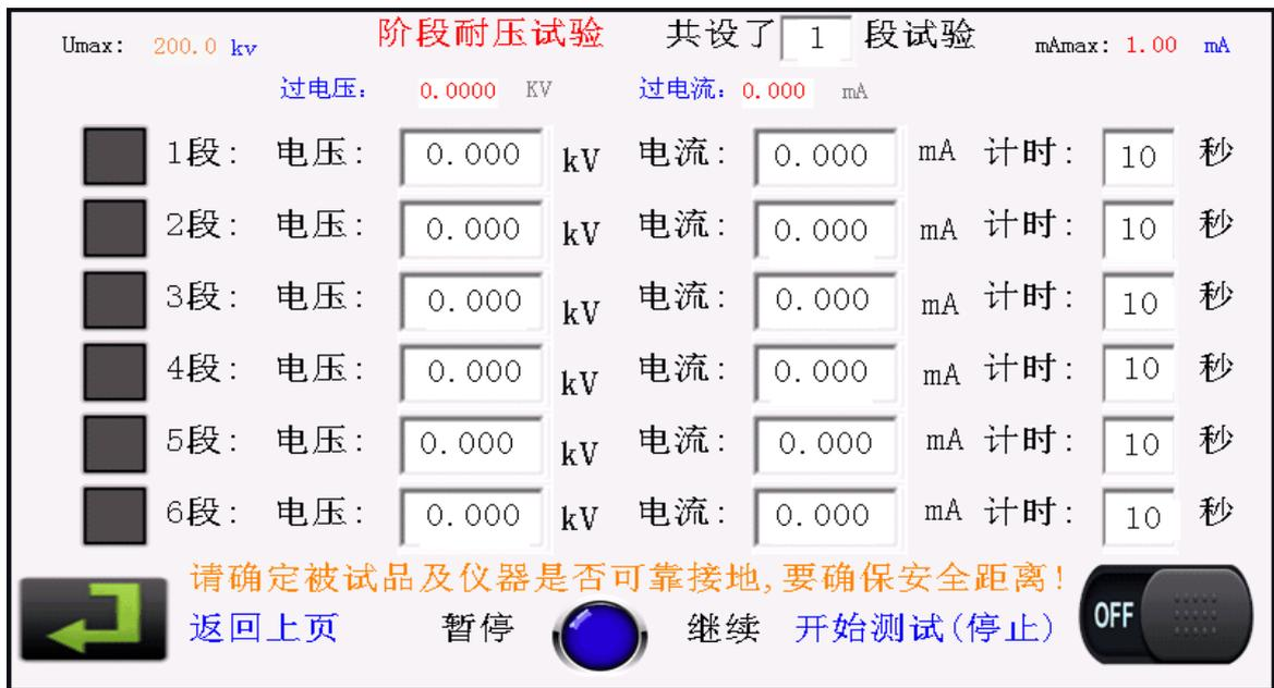
4. 点击“开始测试（停止）”按钮，设备开始升压，此时电源指示灯红灯灭，高压指示灯绿灯亮，表示系统正在加高压。试验人员只需关注试验电压和试验电流的读数即可。试验如果异常，再次点击“开始测试（停止）”按钮一次，可结束试验。
