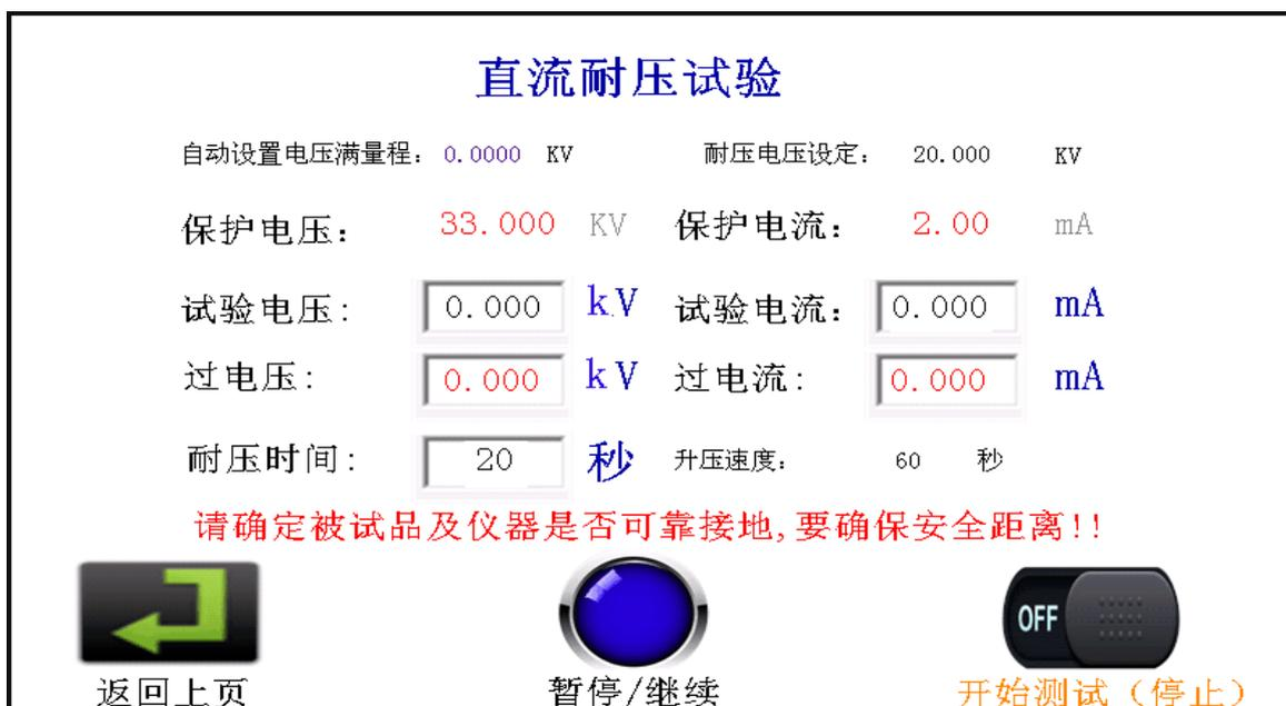
4. 点击“开始测试（停止）”按钮，设备开始升压，此时电源指示灯红灯灭，高压
