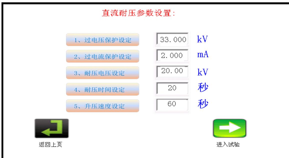
2. 点击方框可进行参数设置，设置电压保护值，电流保护值，被试品试验电压值，被试品耐压时间值，升压速度值。其中：过电压保护一般设置为所需试验电压的 1.1 倍，升压速度代表设备从 0 起升至过电压保护值所需的时间。
