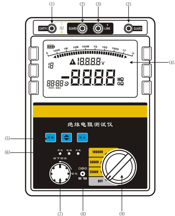
图 1: SMR-10KV 绝缘电阻测试仪面板结构说明
