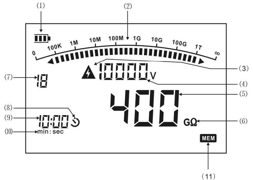
图2: SMR-10KV液晶显示内容
