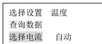
按循环键光标可在**选择设置、查询数据、选择电流**之间移动，按**选择键**可选择测试电流，选定测试电流后，按**确认键**可启动测量。在上图界面中光标不论在任何位置，按**确认键**均可启动测量。
