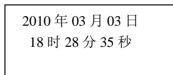
在上图中，按**循环键**可将光标在各个日期数据之间移动，按**选择键**减小数据，按**确认键**增加数据。
