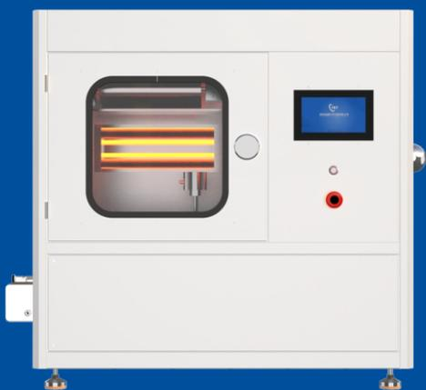
本设备采用创新无针纺丝技术,通过高压电场直接在溶液表面生成纳米纤维,突破传统针头易堵塞瓶颈,实现高通量、连续化生产超细纳米纤维膜(直径50-500nm)。设备具备均匀成膜、材料适应性广等优势,专为生物医疗(组织工程支架/药物缓释膜)、高效过滤(空气/水净化)、能源(电池隔膜)及智能纺织等领域提供高性能纳米纤维制备解决方案,助力科研与产业升级。
