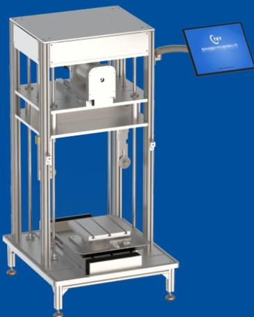
本设备用在贵重宝石、生物塑化标本的切片时,不仅切缝细小而且切割片质量优良,大幅度提高了材料的利用率。本设备是连续切割型金刚石线切割机,设置好切割程序后试样连续进给,无需手动调节,切割后的样品尺寸精度高,在士10 $\mu$ m的范围内。本设备的切割线采用单根线循环往复的运动模式,可使用的线的长度长( $\leq 270$ m),一次上线的使用寿命长,大大提高了切割效率。张紧轮采用气动张紧的模式,气压的大小可根据线径的粗细进行调整,当所使用线径过细时可有效的保护切割线不会因张紧力过大而断裂。
