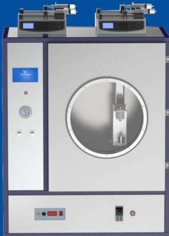
超声波热解喷涂系统采用高频超声波雾化技术,将液态前驱体(金属盐溶液/纳米颗粒悬浮液)转化为微米级均匀液滴,在高温反应腔中瞬时热解形成高纯度、高致密度的功能性薄膜(如氧化物、碳化物涂层)。设备集精准雾化、可控热解与均匀沉积于一体,专为制备燃料电池电解质层、催化电极、高温防护涂层、半导体功能薄膜等高性能材料设计,赋能新能源、航空航天及电子器件领域的尖端研发与量产。
