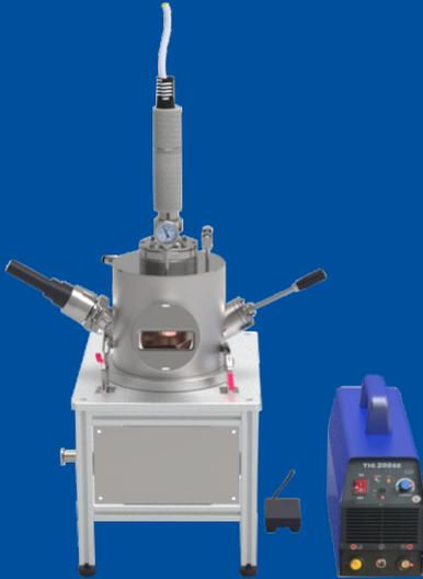
本品是一款小型真空电弧熔炼炉，采用钨电极和水冷铜坩埚。设备熔炼温度可超过3000℃，且降温迅速。采用不锈钢水冷腔体，配有观察窗口和照明窗口，可观测样品熔炼情况，非常适合样品熔炼和热处理，相图研究。熔炼时，金属放置在水冷铜坩埚内，炉内充入高纯的惰性气体，利用电弧产生的高温熔化金属。该设备具有体积小，性能稳定，操作简单方便等优点。
