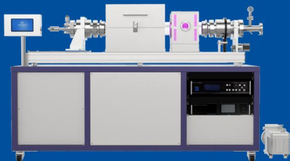
粉体包覆磁控镀膜仪是通过粉体在溅射腔室内的旋转,以达到粉体表面均匀包覆的效果。腔室可旋转、倾斜,能快速出料。粉体包覆是指将一种或多种粉体颗粒投入到包覆设备中,通过物理或化学方法形成一层覆盖在颗粒表面的物质。粉体包覆的目的可以是改变颗粒表面的性质、增加颗粒的稳定性、控制颗粒的释放速率等。
