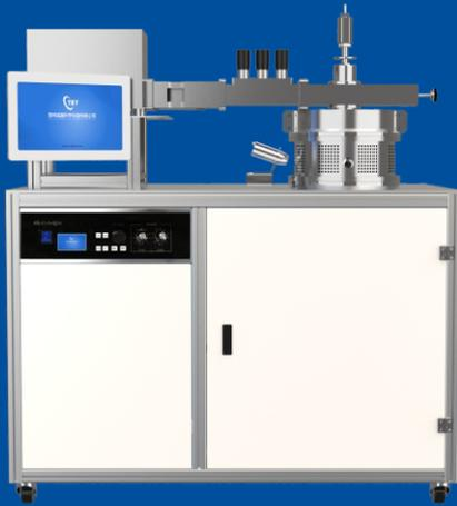
本产品为不锈钢腔体式6kw微波等离子体设备，功率密度高，水冷式基片台和水冷式金属反应腔，保证系统能长时间稳定工作；基片温度以微波等离子体自加热方式达到；真空泵及阀门采用涡轮分子泵(极限真空为 $1 \times 10^{-5}$ Pa)和旋片式机械真空泵(极限真空为1Pa)，系统可自动控制沉积气压；全自动工艺控制模块，可以稳定可靠地制备高品质金刚石薄膜和晶体。
