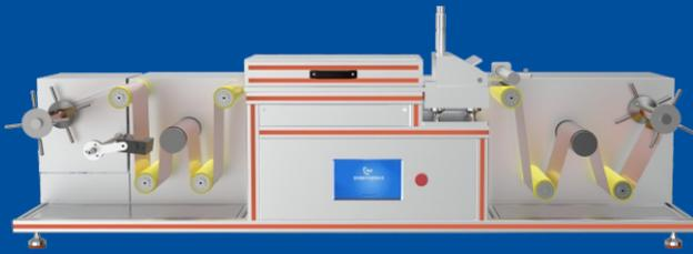
这是一款专为连续卷状柔性基材(如金属箔、塑料薄膜)设计的高精度涂布设备。通过精密狭缝挤出浆料或溶液,在高速运行的基材上形成均匀、超薄的湿膜(厚度精度可达 $\pm 1\mu\text{m}$ ),结合在线干燥/固化系统,实现高效、稳定的卷对卷(R2R)连续生产。适用于对涂布均匀性和一致性要求极高的领域,是新能源电池(电极/隔膜)、光学薄膜、功能性涂层及印刷电子等先进制造行业的理想选择。
