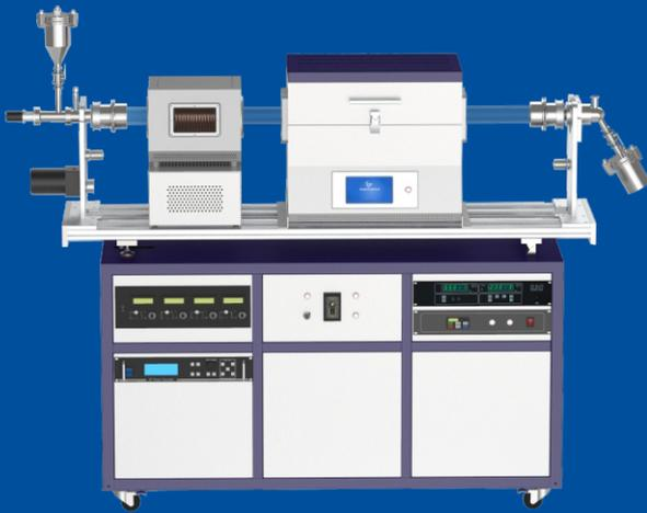
本设备为等离子增强型旋转石墨烯制备系统。设备由旋转及倾斜机构、单温区管式炉、等离子发生机构、质量流量计供气系统、高真空分子泵组等部分构成。相比于其他的石墨烯制备设备,本设备能够提供更高的基底真空,能够提高产物质量;能够利用旋转和倾斜机构实现连续生产,并且可以使颗粒型样品表面均匀生长产物;等离子发生装置能够显著降低反应温度,提高反应效率。
