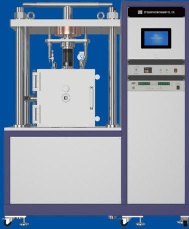
该设备采用石墨作为加热体,可在高真空或惰性气氛环境中于2000℃高温下长期稳定工作。其核心功能在于为粉末冶金材料(如难熔金属钨钼合金、金属基复合材料)、结构陶瓷(氮化硅、碳化硅)、无机化合物(金属氧化物、碳化物)及纳米材料(纳米晶金属、陶瓷粉体)等提供真空或保护气氛下的加热压制环境,通过精准调控温场与机械压力的协同作用,实现材料的致密化成型与成品制备,尤其适用于需要抑制氧化、促进界面扩散或保留纳米尺度特性的工艺场景。
