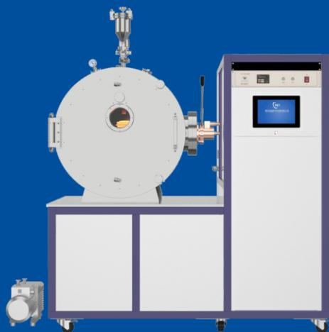
真空感应熔炼炉在高真空/惰性气体双环境下, 通过电磁感应涡流直接加热金属材料, 实现无污染熔炼(氧含量 $\leq 5\text{ppm}$ )、超精准合金化(成分偏差 $< 0.5\text{at}\%$ )及定向凝固控制。专为活性金属(钛/锆)、高温合金、磁性材料及高纯单晶的研发而设计, 攻克易氧化组分熔炼、亚稳相调控等关键技术瓶颈, 赋能航空航天、核能、生物植入体等尖端材料创新。
