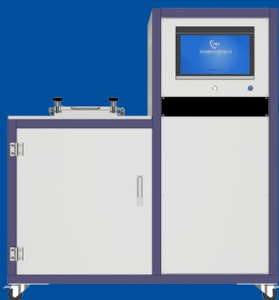
原子层沉积系统(ALD)通过交替通入前驱体气体,在基材表面发生自限制性化学反应,实现亚纳米级精度薄膜沉积(精度 $\pm 0.1\text{nm}$ )。具备极致三维保形性、无针孔缺陷等特性,专为半导体栅极介质、纳米器件封装、量子点钝化等原子级涂层需求设计。
