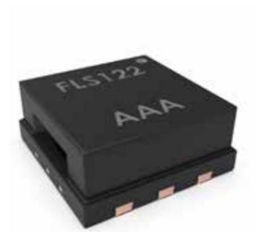
6针DFN封装 3.5 mm × 3.5 mm 占位面积 2 mm 总高度
