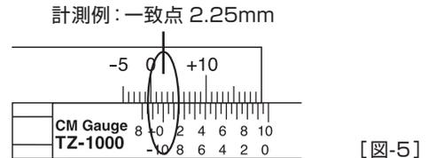
計測範囲 -5mm~5.7mm (分解能0.05mmの場合)
