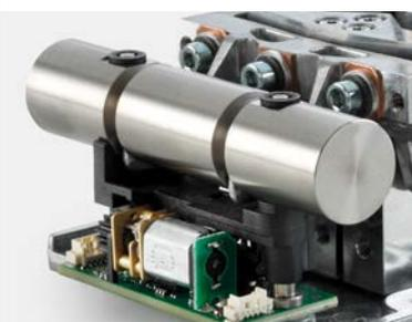
采用电磁力补偿技术 (EMFC) 的称量单元融入了 FACT 技术，利用内置砝码自动校正天平，即使当环境温度变化时依然可确保结果准确。
