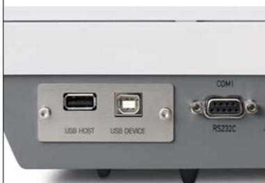
配备 USB 与 RS232 端口，另外选配蓝牙适配器，这些可帮助您连接条形码扫描器、打印机甚至电脑。数据传输快速简便，并且可避免出现抄录错误。
