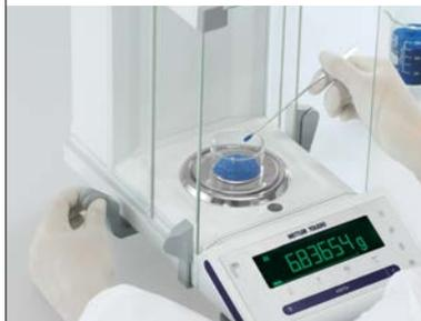
减少每次称量所需的移动次数：ErgoDoor 可使您用左手打开右侧门（反之亦然），因此可提高称量速度和舒适性。
