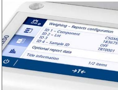
配置结果和相关称量数据的保存、打印和导出方式。可将 PDF、CSV 与 XML 文件保存至 U 盘或者 FTP 服务器。
