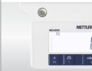
配有大尺寸调节脚, 可轻松对天平进行调平。水平泡位于前端, 便于检查水平度, 确保天平准确运行。
