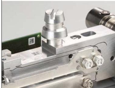
优异的单模块传感器称量单元具有自动内部校正功能，可提供始终可靠的结果。内置过载保护功能可确保天平使用寿命长久。
