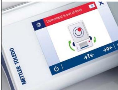
当天平非水平时，内置 LevelControl 水平控制功能发出警告，并在屏幕上提供指导，帮助您在最快的时间内将天平调至水平。
