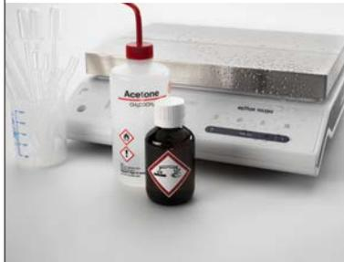
秤盘和天平外壳可抵御最强腐蚀性化学品（例如丙酮），同时还可确保天平使用寿命长久。
