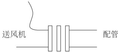
在【吸入空气温度 60°C 以上】使用耐热型送风机时,考虑到【热膨胀】,请使用耐热性的接头等避免配管的热膨胀。
