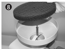
拆卸下终端过滤器，进行更换。
