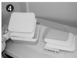
按序拆卸下一次过滤器（薄的部分）、间隔网、二次过滤器（较厚的部分）。
