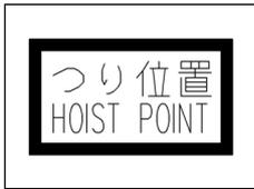
つり上げる場合は必ずつり位置表示のあるつり穴を使用してください。指定以外の場所で使用すると、変形や転倒、落下の恐れがあります。
